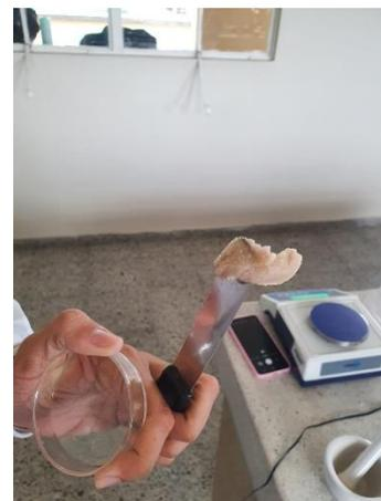
Después de haber obtenido el almidón de yuca modificado, se procedió al proceso de secado de este por medio de un horno, en el cual se dejó reposando la muestra, exponiéndola a un calor constante. En la imagen se muestra la muestra de polímero que nos logramos obtener.
